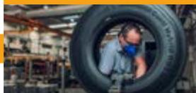
Devolver à carcaça a condição de uso por meio do correto tratamento, dimensionamento e aplicação dos reparos, restabelecendo a resistência à estrutura do pneu por meio da aplicação de manchão/reparo na área danificada e tratada.
