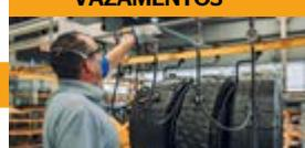
Realizar o teste do conjunto montado através de sucção pela bomba de vácuo, verificando a ausência de furos e microfuros causadores de vazamentos.
