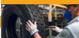
Verificar a qualidade do serviço executado. Classificar o pneu para ser utilizado ou retornar para correção. Impedir que pneus com falhas cheguem ao cliente.
