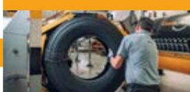
Remover da autoclave e desmontar o conjunto pneumático, preservando os componentes corretamente.
