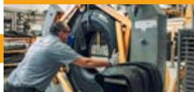
Envelopar o pneu corretamente, garantindo a aderência entre carcaça, ligação e banda durante a vulcanização.
