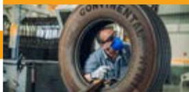
Inspecionar as carcaças, selecionando-as de acordo com a condição. Evitar trabalhar carcaças danificadas que precisem ser recusadas durante a execução do processo de recapagem ou estejam fragilizadas e apresentem falhas após a reconstrução.
