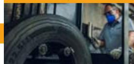
Proteger a área raspada e escareada aplicando uma camada de cola cimento, evitando a oxidação da borracha e dos cordões de aço.
