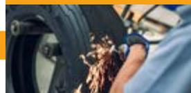
Tratamento e eliminação de danos na carcaça. Remoção de material avariado (têxtil ou aço), fazendo uso das ferramentas apropriadas.
