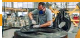
Realizar a montagem do conjunto envelope e innerlop, proporcionando a junção adequada entre conjunto de forma que não haja vazamento de ar.
